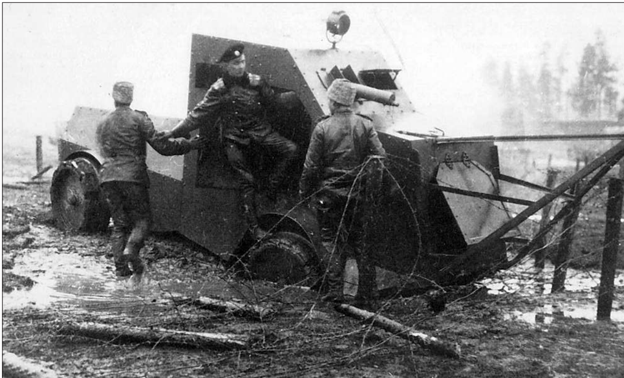
Бронеавтомобиль «Джеффри» во время испытаний по преодолению проволочных заграждений на полигоне Офицерской стрелковой школы, октябрь 1916 года. На подножке машины — штабс-капитан Поплавко
