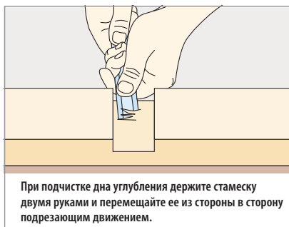
Для удаления отхода из глубокого паза используйте плоскую стамеску и киянку.
